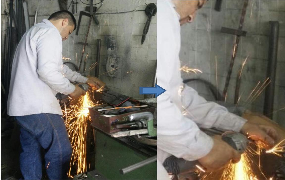
**Figura N.º 2. Manipulación de cortadora sin elementos de protección personal.**
